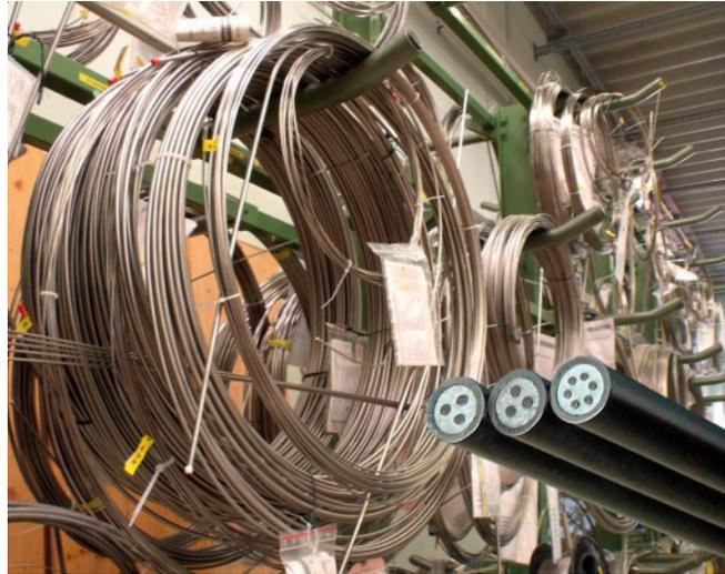
矿物绝缘电缆（MI 电缆）
